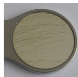
фиг. 3 Надрасквания/следи от почистване
