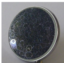
Figura 4 Manchas de calcário
