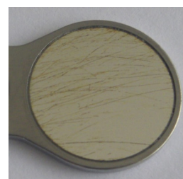
Figura 3 Riscos/marcas de lavagem
