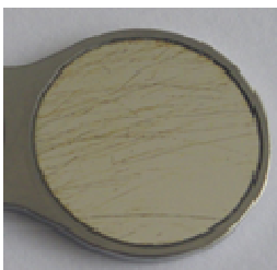
Figura 3 Riscos/marcas de lavagem
