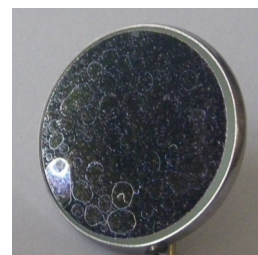
Figura 4 Manchas de calcário
