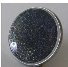
Figura 4 Manchas de calcário
