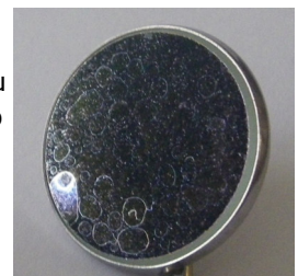
Figura 4 Manchas de calcário
