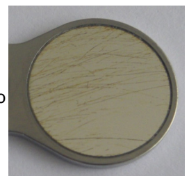
Figura 3 Riscos/marcas de lavagem
