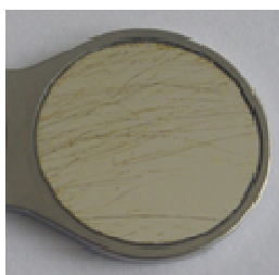
Imaginea 3 Zgârieturi/urme de curățare
