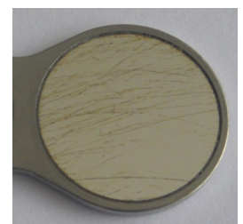
Imaginea 3 Zgârieturi/urme de curățare
