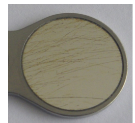
Figura 3 Arañazos/marcas de limpieza
