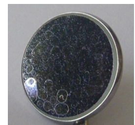
Figura 4 Manchas de cal
