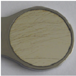
Figura 3 Arañazos/marcas de limpieza
