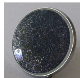
Figura 4 Manchas de cal
