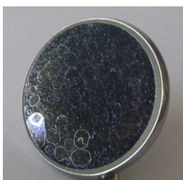
Figura 4 Manchas de cal
