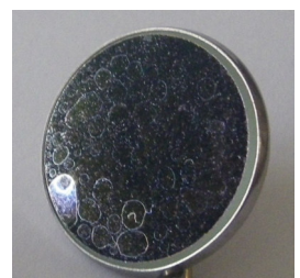
Photo 4 Taches de calcaire
