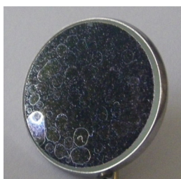
Photo 4 Taches de calcaire
