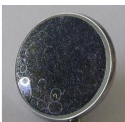
Photo 4 Taches de calcaire
