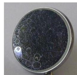
Photo 4 Taches de calcaire
