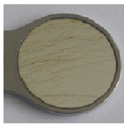
фиг. 3 Надрасквания/следи от почистване
