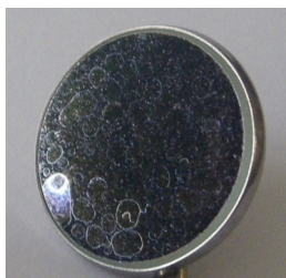
Slika 4 Madeži vodnega kamna
