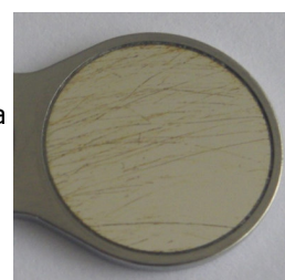
Imaginea 3 Zgârieturi/urme de curățare
