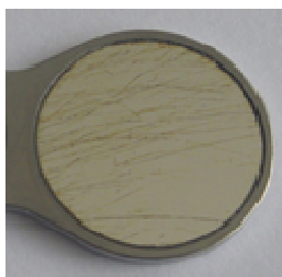
Imaginea 3 Zgârieturi/urme de curățare
