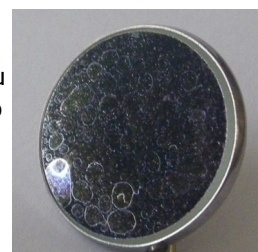
Figura 4 Manchas de calcário
