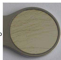
Figura 3 Riscos/marcas de lavagem
