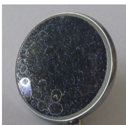
Photo 4 Taches de calcaire
