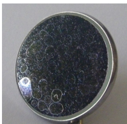
Figura 4 Manchas de cal
