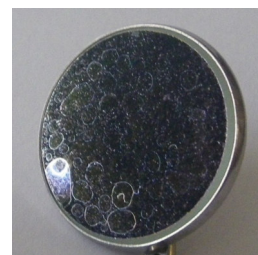
Figura 4 Manchas de cal
