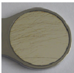
Figura 3 Arañazos/marcas de limpieza
