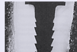
EXATEC-S Wurzelstift exakt passgenauer Sitz mit Glasionomerzement Ketac Cem Radiopaque, auf Grund der kleinen Korngröße von 0,1 bis 1,2 µm (Vergrößerung 10x)
