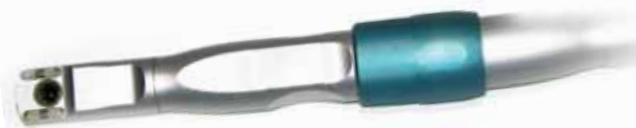
Intraorales Kamerahandstück: drehbarer Objektivkopf mit vier LED, Griff mit Auslöserplatte, grüner Focusing (hier für OK-Aufnahmen eingestellt)
